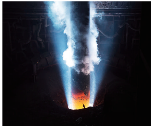
黒鉛電極は、電気炉製鋼法において鉄スクラップを溶かす際に使用されます。電気炉製鋼法は、高炉製鋼法と比較して、CO 2 排出量を約4分の1に抑制できることから、環境負荷低減を目的とした電炉鋼比率の上昇が予想され、黒鉛電極需要の高まりが期待できます。
