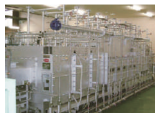
LiB電池焼成用 工業炉
