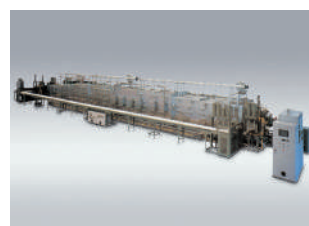
MLCC焼成用 工業炉
